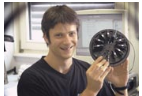
Marcus Reicherter hatte bereits in Stuttgart Physik studiert. In seiner Master-Arbeit wurde eine Streulichtmesskammer mit all ihren Parametern rechnerisch simuliert und eine Marktstudie über Kundenbedürfnisse zu Streulichtrauchmeldern erstellt. Die Simulation soll helfen, in Zukunft Änderungen oder Neugestaltungen von Messkammern hinsichtlich ihrer optischen Eigenschaften vorab bewerten zu können.
