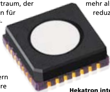
Hekatron integriert die Kernfunktionen eines Brandmelders in einen Mikrochip. Das Ergebnis sind winzige Brandmelder, die bisher nicht gekannte Einsatzmöglichkeiten bieten.
