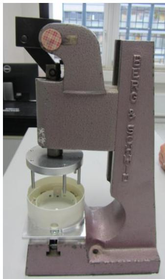
Führungsring in Einpressvorrichtung platzieren und nach oben drücken
